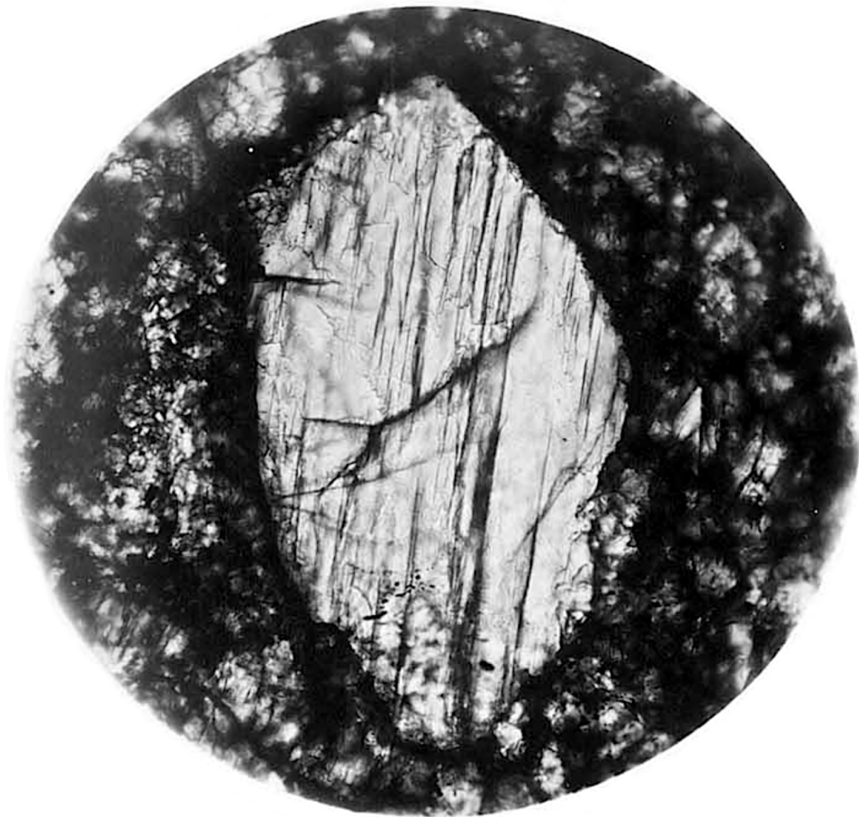
21: Figur 1 — Bronzit in dem Stein von Shalka. Vergrößerung 160.
