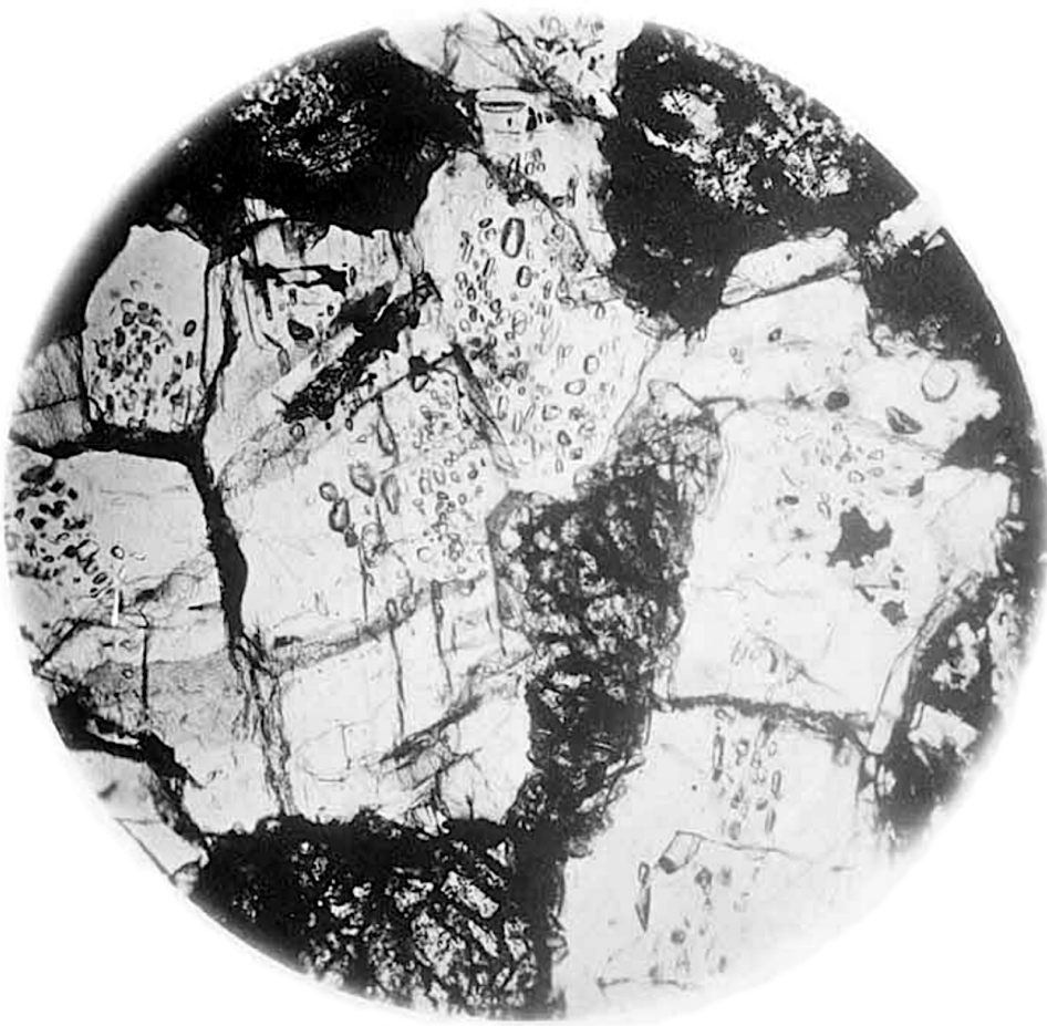
88: Figur 4 — Plagioklas mit Einschlüssen. Grahamit von der Sierra de Chaco. Vergrößerung 60.
