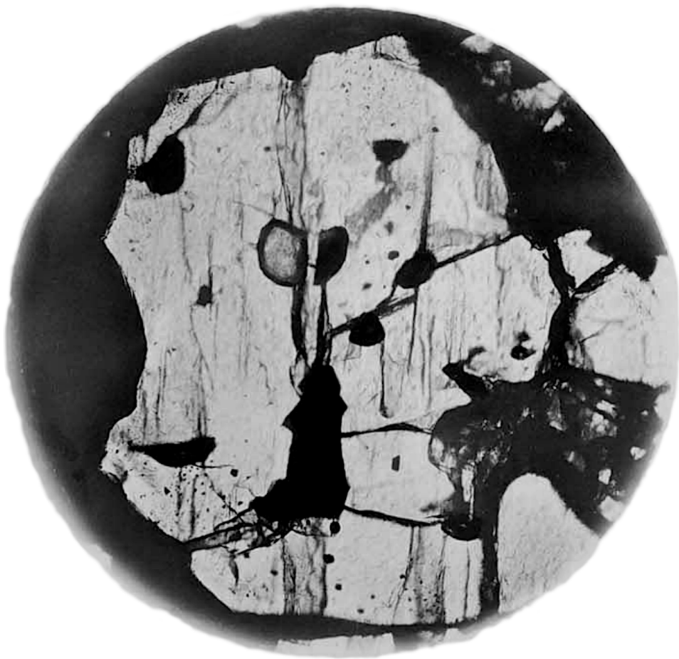
99: Figur 3 — Bronzit in demselben Siderophyr. Vergrößerung 60.
