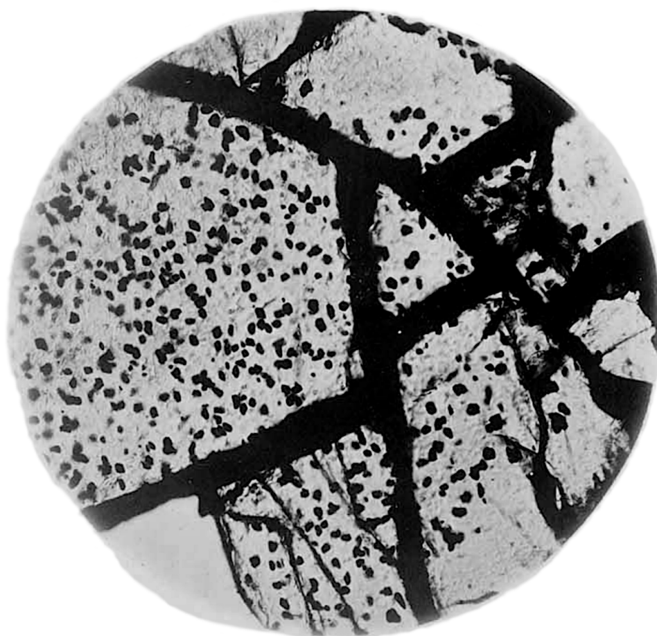
95: Figur 3 — Olivin mit Einschlüssen im Mesofidrit von Gaiholz. Vergrößerung 120.
