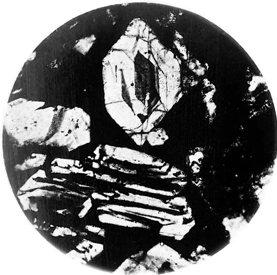
33: Figur 1 — Olivinkristall in einem glasreichen Kugelfchen des Steines von Borkut. Vergrößerung 160.
