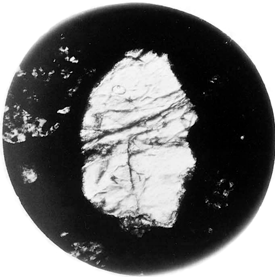
71: Figur 3 — Glaseinschluss mit Libelle im Olivin des Steines von Lancé. Vergrößerung 300.
