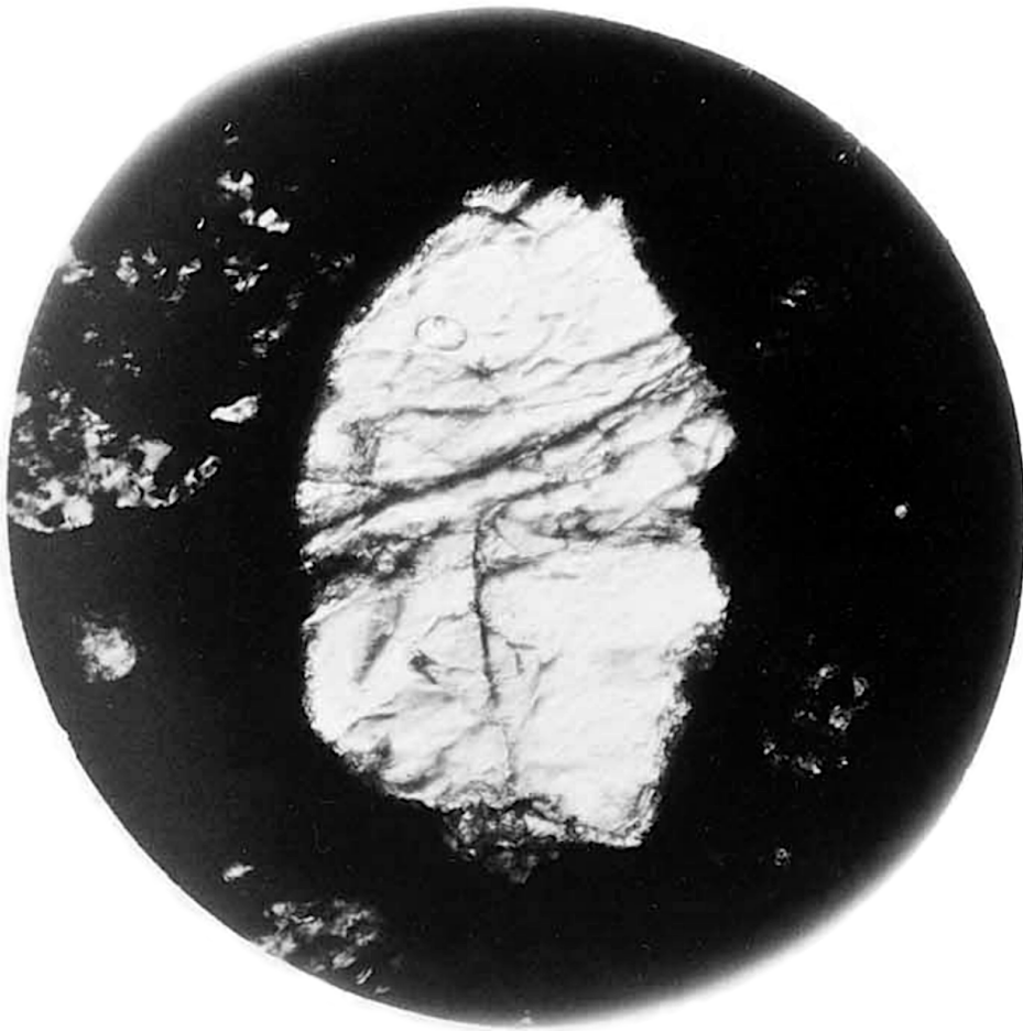
71: Figur 3 — Glaseinschluf mit Libelle im Olivin des Steines von Lancé. Vergrößerung 300.
