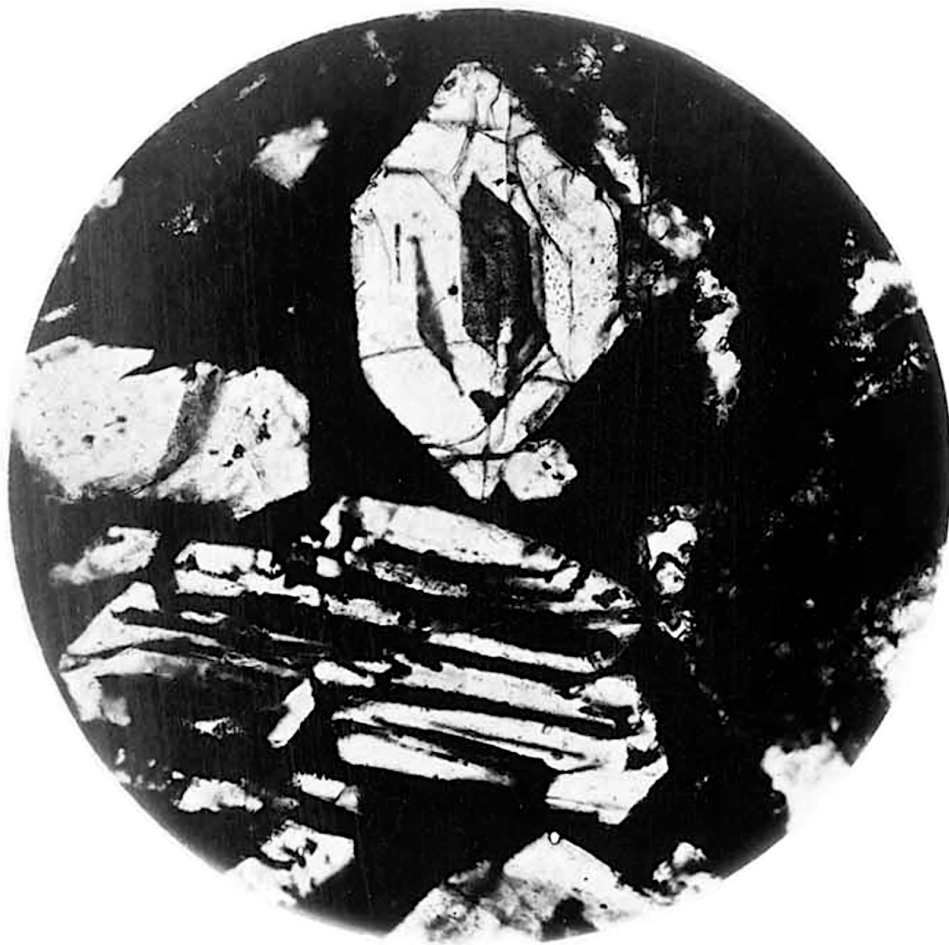
33: Figur 1 — Olivinkristall in einem glasreichen Kugeln des Steines von Vorkut. Vergrößerung 160.
