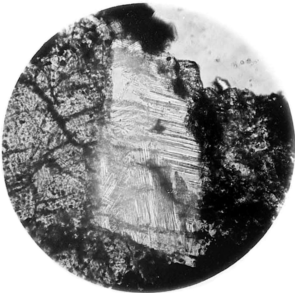
7: Figur 3 — Anorthit mit langgezogenen Glaseinschlüssen. Eufrit von Ivinaf. Vergrößerung 160.
