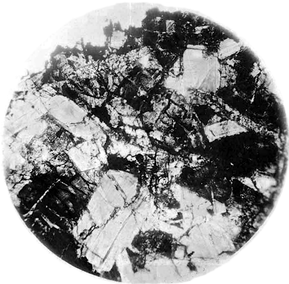
4: Figur 4 — Eufrit von Juvinaf. Mit Durchschnitten von Lamellen eines gelben Silikates. Vergrößerung 75.
