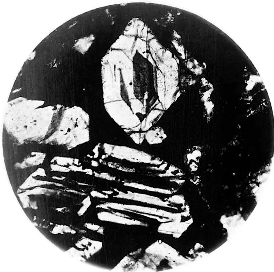
33: Figur 1 — Olivinkristall in einem glasreichen Kügelchen des Steines von Borkut. Vergrößerung 160.
