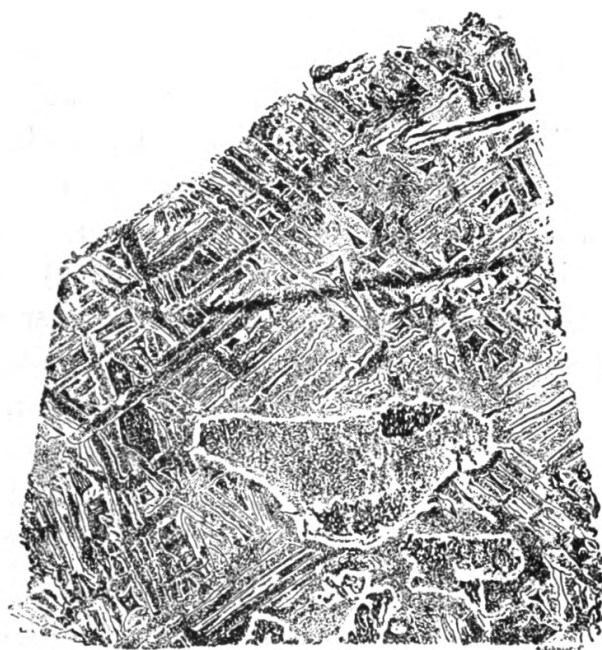
32: Fig. 32. — En järnmeteorit etsad med salpetersyra, hvarigenom strukturen framträder.
